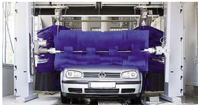
Die abschließende Trocken- und Polierstation massiert vorab aufgetragene Wachse und Politur ein und sorgt für intensiven Hochglanz. Fotos: privat
